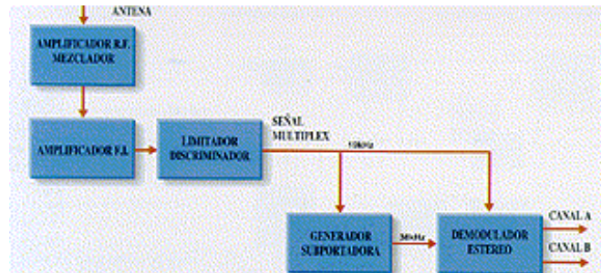
Esquema de bloque de un receptor de FM estéreo
