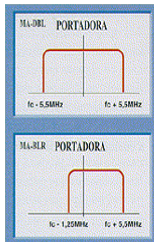
A) espectro de una señal MA-DBL. B) espectro de una señal MA-BLR.
